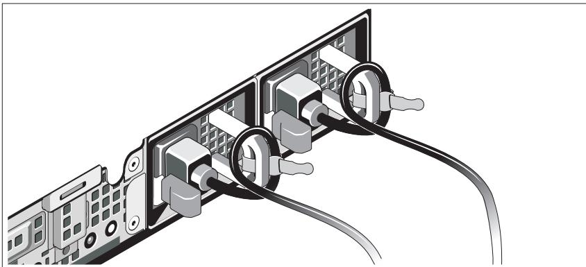
Tekuk kabel daya sistem secara melingkar seperti ditunjukkan pada gambar kemudian kencangkan kabel dengan pengikat yang tersedia. Tancapkan ujung kabel daya yang lain ke stopkontak listrik yang ditanahkan atau sumber daya terpisah seperti catu daya tak terputus (UPS) atau unit distribusi daya (PDU).
