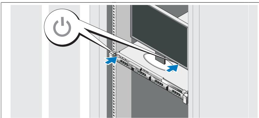
システムとオプションのモニター（使用している場合）の電源ボタンを押します。電源インジケータが点灯します。
