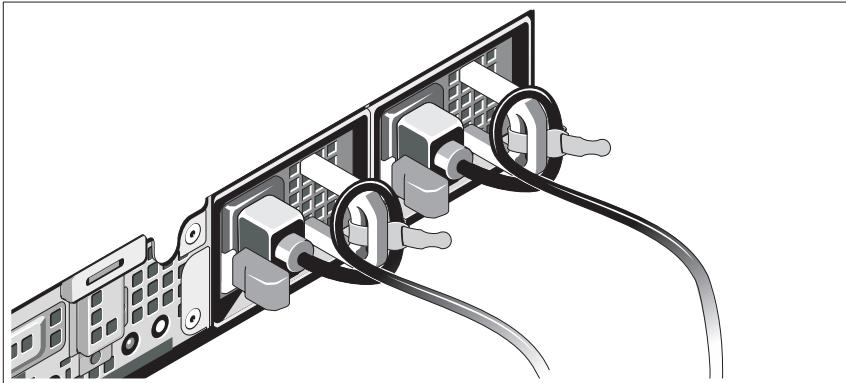
如图所示，将系统电源电缆弯成环状，并使用提供的扎带将其固定到支架上。将电源电缆的另一端插入接地的电源插座或单独的电源，如不间断电源设备 (UPS) 或配电装置 (PDU)。
