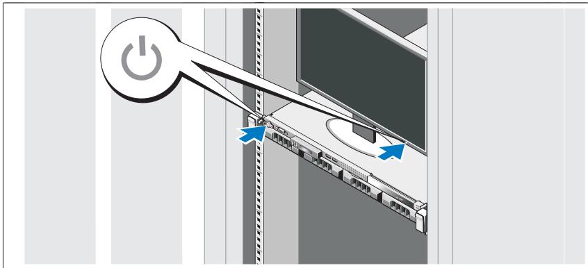
按下系统和可选显示器（如有使用）上的电源按钮。电源指示灯将会亮起。
