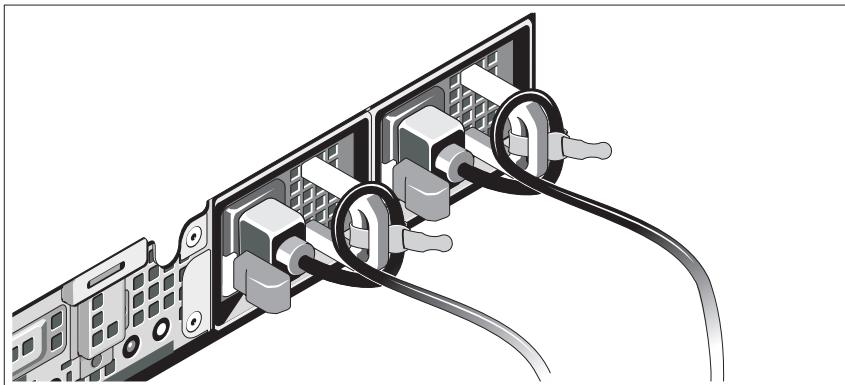
시스템 전원 케이블을 그림에 표시된 대로 루프 모양으로 구부리고 제공된 스트랩을 사용하여 브래킷에 케이블을 고정시킵니다. 전원 케이블의 반대쪽 끝을 접지된 전원 콘센트나, UPS (무정전 전원 공급 장치) 또는 PDU (배전 장치)와 같은 별도의 전원에 연결합니다.
